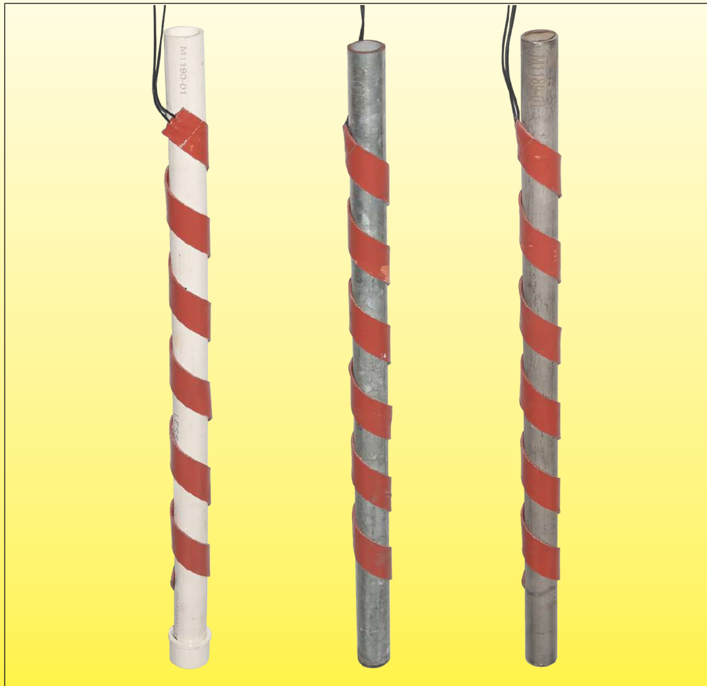
Condition des essais comparatifs : Bandes chauffantes en silicone enroulées sur des tubes de diamètre extérieur 25mm en PVC-U, acier galvanisé et acier inoxydable
